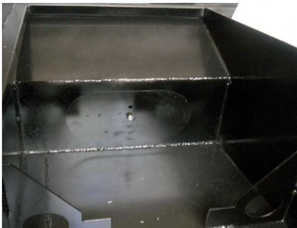
Рис.2 Клапан в закрытом положении
