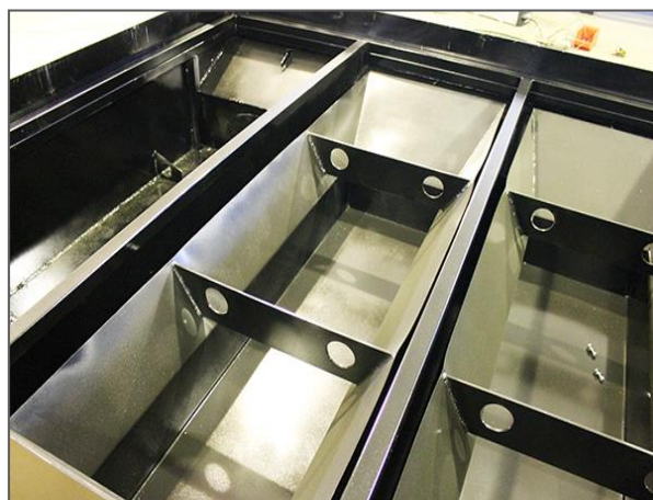
Рис.6 Внутренние ёмкости для сбора окалины
